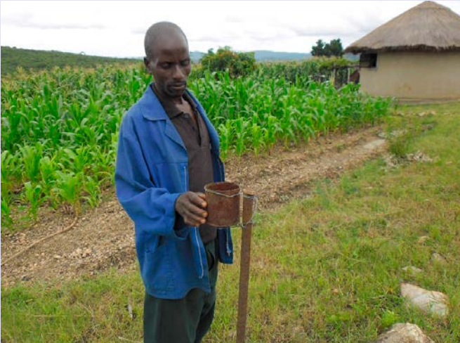
4. Shurugwi'de Koruma Tarımı (KT) ile uğraşan bir çiftçi. Boş bir tenekeden yağmur ölçer yapmış.
